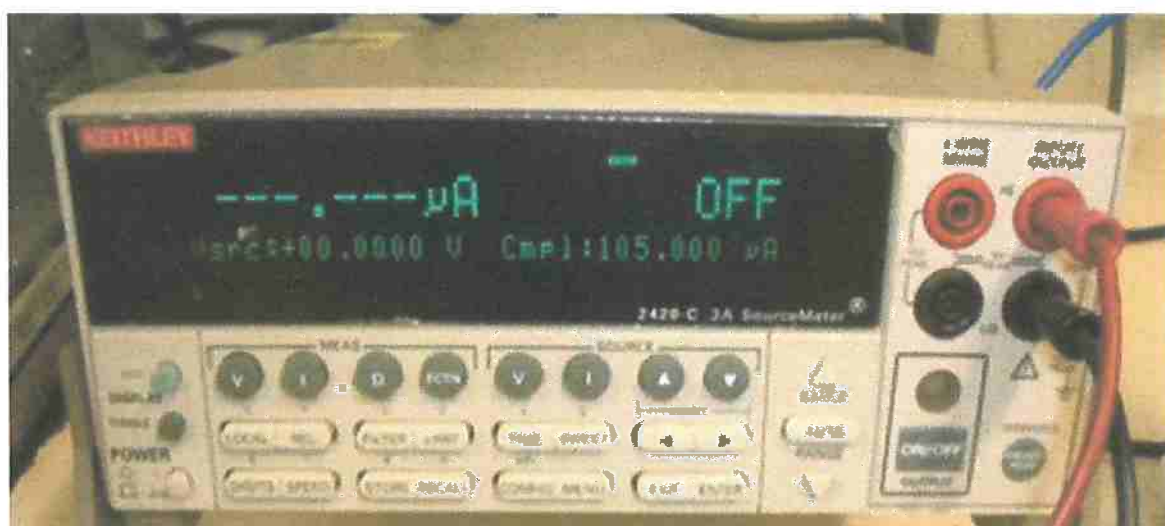
Figura 23 - Foto do medidor e fonte e corrente e tensão, mostrando também o visor indicando os valores de corrente e tensão aplicados ao dispositivo (Santos, 2009).
