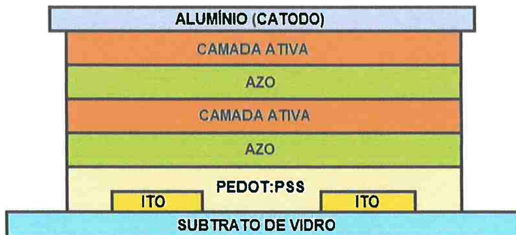
Figura 34 - Arquitetura das PSCs heterojunção montadas.
