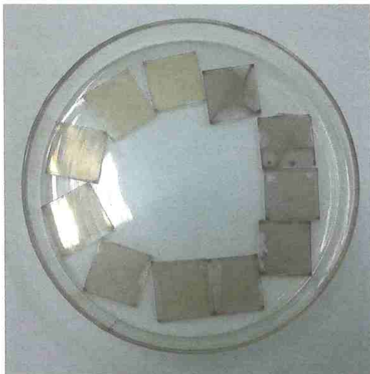
Figura 37 – Filmes da blenda depositados sobre lâminas de vidro para o teste de extinção de fluorescência.
