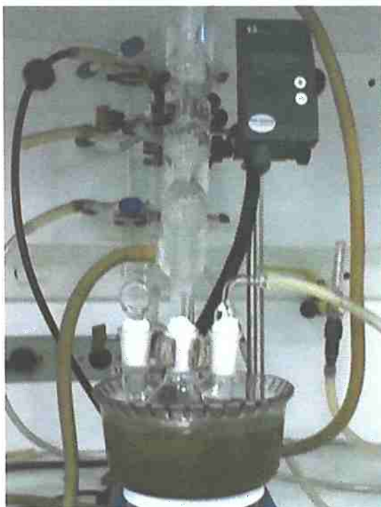
Figura 30 - Foto do sistema experimental contendo o balão de duas bocas, banho termostático de silicone, placa de aquecimento e agitação magnética, condensador, hastes e termômetro.
