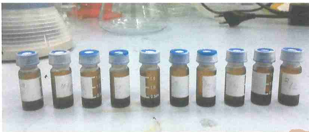
Figura 36 - Soluções de diferentes proporções PFTB:fulereno utilizadas no teste de extinção de fluorescência.
