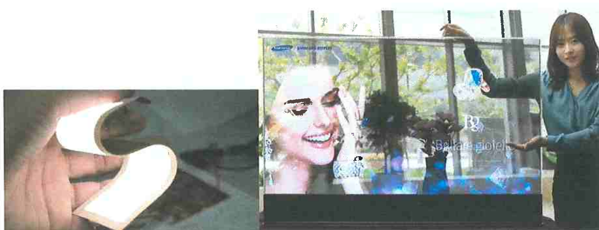
Figura 9 - Exemplos de P-OLEDs em aplicações comerciais. Dispositivos emissores finos, leves e flexíveis.
